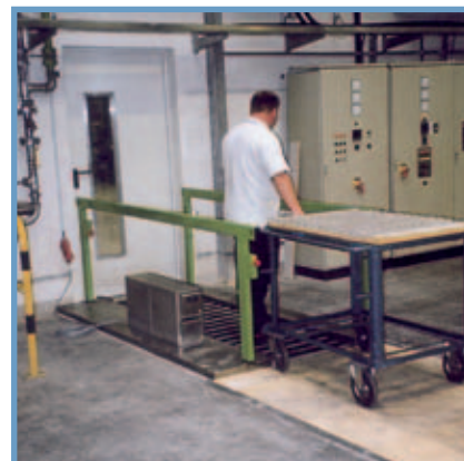
Torr rengöring av hjul eller sulor Dry-cleaning of tires and soles
