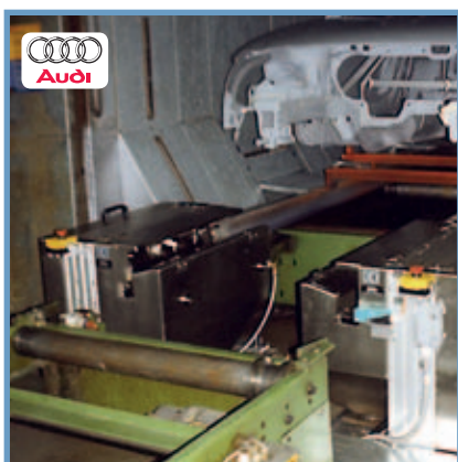
Anläggning för skid-rengöring Skid cleaning unit.
