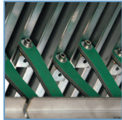
Hela enheten är underhållsfri eftersom rörliga delar sitter skyddade från smuts The entire unit is free of maintenance as the drives are dirt-protected
