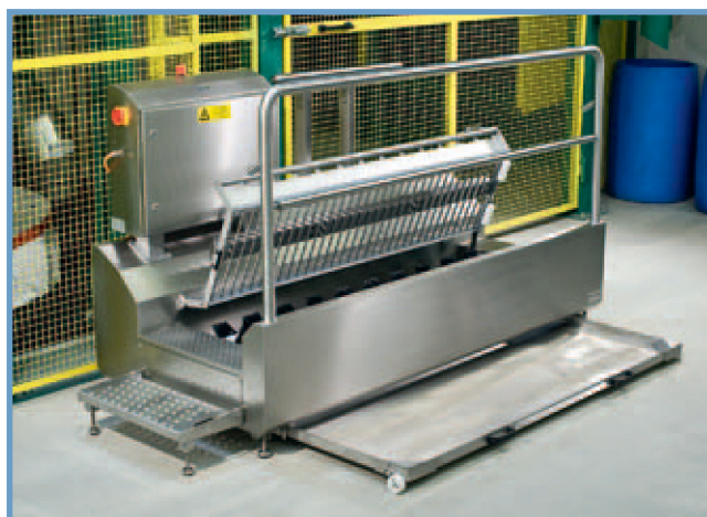
Rengöring är enkelt och görs genom att lyfta på gallret och dra ut det rostfria tråget Cleaning is made easy due to tiltable grates and removable stainless steel bin
